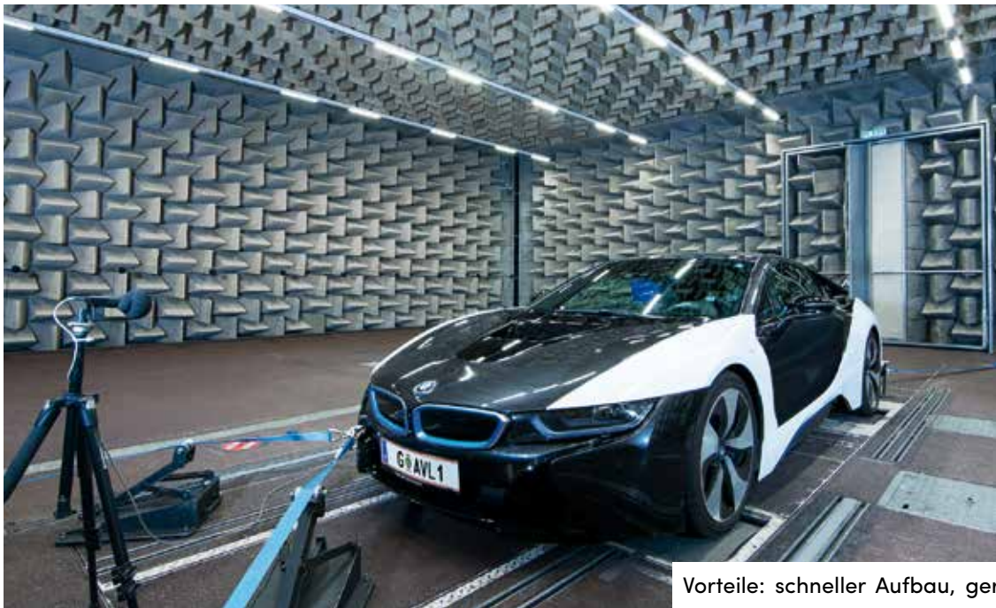
Soundtest eines Elektroautos im Akustiklabor der Firma AVL, Graz, 2015 (AVL List GmbH)
